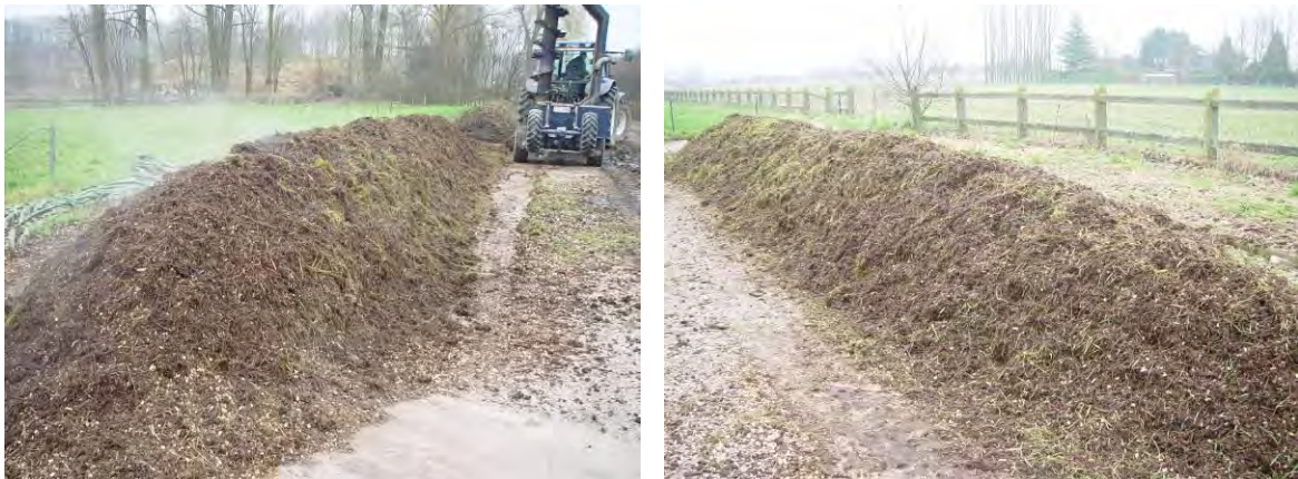
Figuur 3. Opzet van de composthopen met een compostkeerder type Sandberger.
